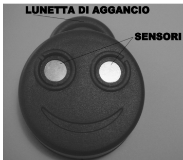
fig.4) LATO FRONTALE TRASMETTITORE
