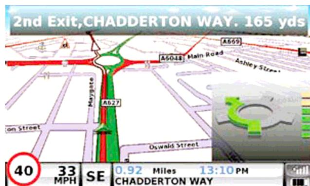
**Suggerimento:** se si manca una svolta o si imbecca una strada sbagliata, viene calcolato automaticamente un nuovo itinerario più veloce basato sulla nuova posizione e direzione di marcia, e un segnale acustico conferma il cambio di itinerario. Truckmate fornisce sempre istruzioni precise per raggiungere la destinazione prescelta.
