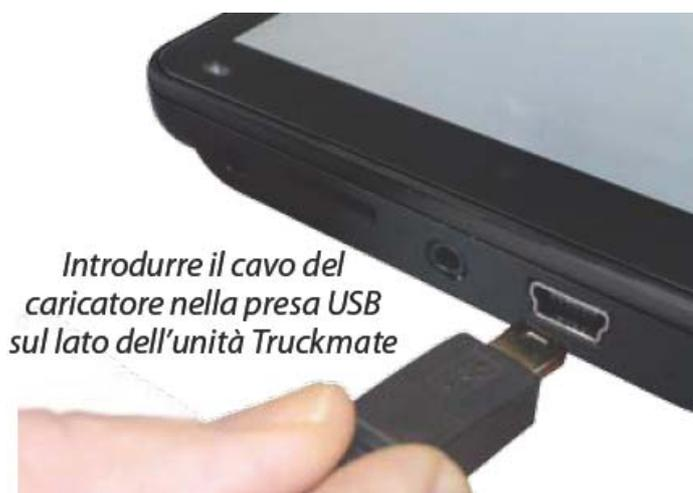
utilizzando il caricabatterie da 240 V CA. Quando è nuova, la batteria di Truckmate ha una carica parziale.
