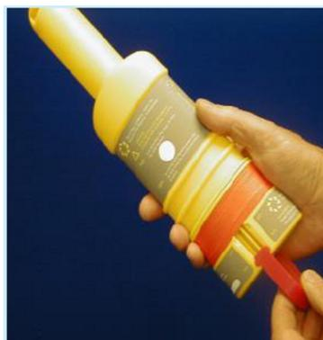
Passare un'estremità della cinghia nera sopra la parte superiore del tubo di supporto e legare la cinghia per consentire al SART di appendersi al centro dell'imbarcazione. In alternativa, montare la SART sull'asta telescopica in dotazione (opzione).
