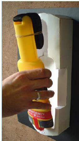
Tirare saldamente verso il basso la clip rossa di attivazione per accendere il SART. Il LED lampeggia lentamente. Quando si trova nel raggio d'azione di un segnale radar, il LED lampeggia rapidamente.
