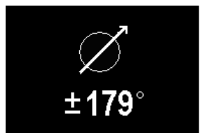
Allarme vento/prua impostazione angolo
