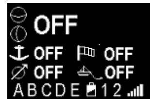
Attivazione allarmi locali Strumenti NMEA OFF
