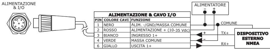
Connessione NMEA Esterno sulla Porta 1
