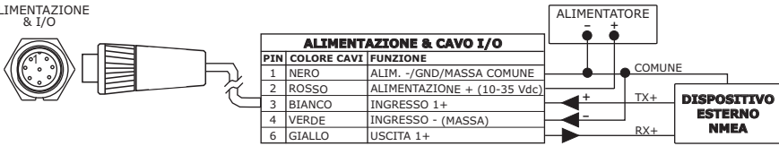
Connessione NMEA Esterno sulla Porta 1
