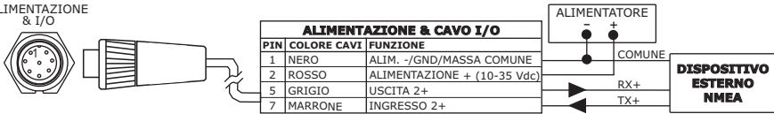
Connessione NMEA Esterno sulla Porta 2
