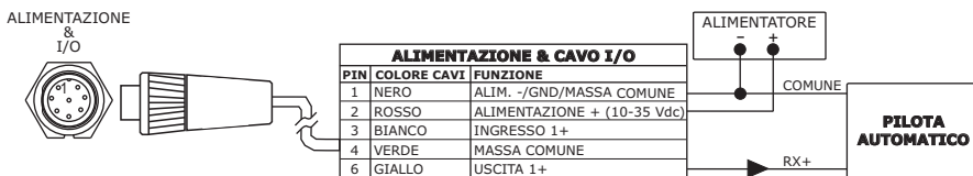
Connessione Autopilota sulla Porta 1
