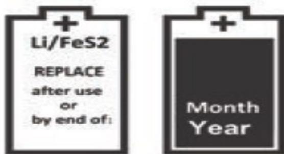
La piena capacità operativa dell'EPIRB potrebbe non essere disponibile se le batterie montate hanno superato il periodo di sostituzione di 10 anni dalla data di produzione del beacon, come indicato sul corpo dell'unità. (vedi etichetta sopra).
