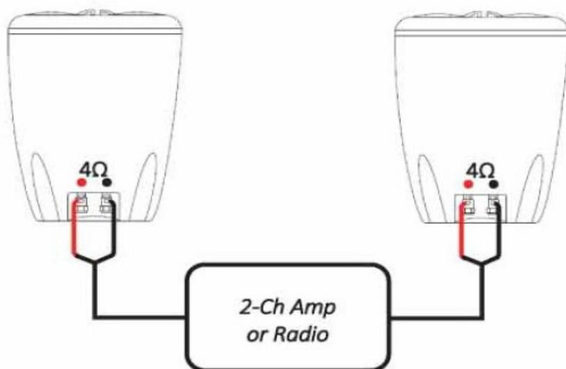
Le casse hanno un'impedenza di 4 Ohm cadauna, potete connettere ciascuna cassa direttamente all'output dell'unità principale. Per una migliore resa si raccomanda di collegare le casse ad un amplificatore che abbia impostato il filtro passa-alti intorno ai 120Hz..
