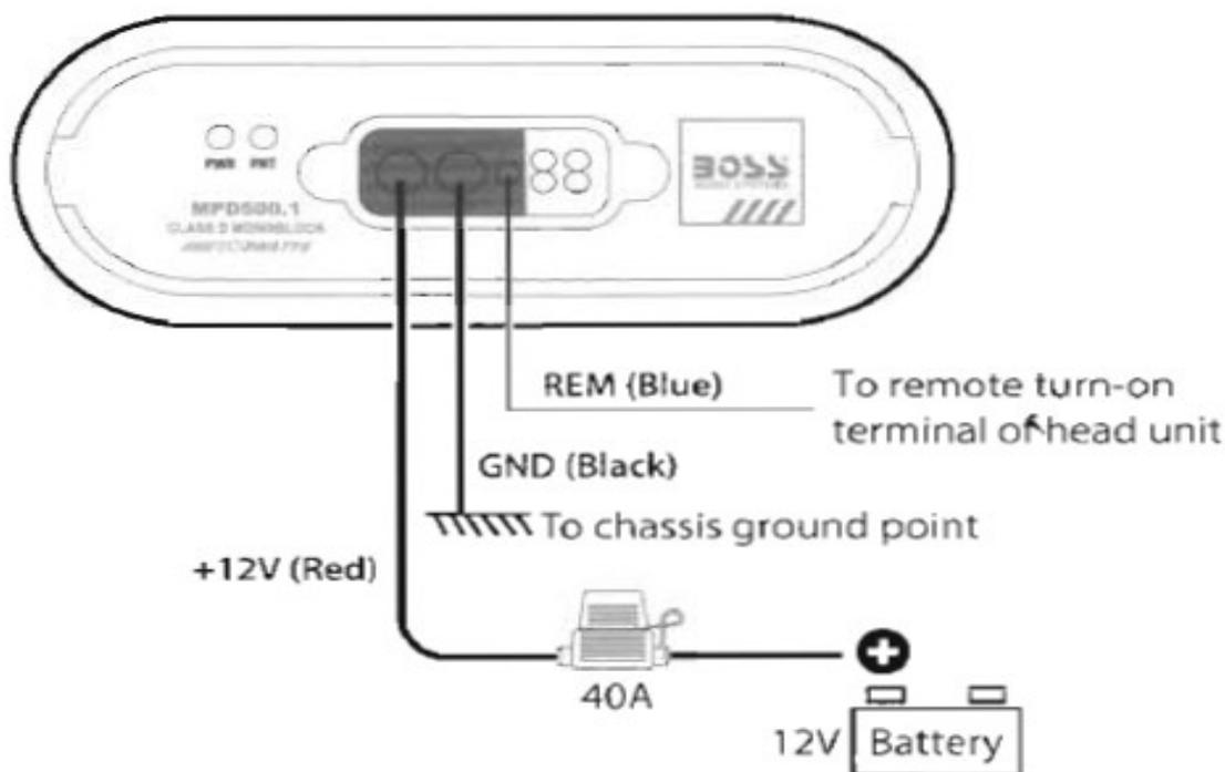
**1.** Collegate il cavo di massa nero (etichettato "GND") dell'amplificatore al telaio metallico (chassis) del veicolo. Se si prolunga il cavo di terra, utilizzare un cavo di calibro 8 (o più pesante). Mantenere il cavo di terra il più corto possibile. Raschiare la vernice, la ruggine o la sporcizia dal punto di massa (per ottenere un contatto pulito). Fissare il cavo di terra sul punto di massa con una vite o un bullone.
