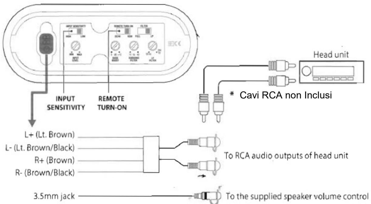
\*Con dei cavi RCA (non inclusi), collegare i connettori RCA femmina dell'amplificatore alle uscite audio RCA dell'unità principale.
