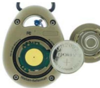
Quando la Batteria viene inserita : L'Unità è accesa. (Si spegne solo se la batteria viene rimossa), Il Bluetooth è attivo, il dispositivo sta registrando dati.
