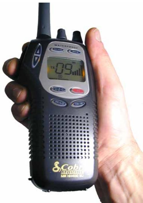
VHF ricco di funzionalità e pienamente affidabile in qualsiasi condizione d'uso. Il Cobra HH400 è infatti dotato di tutte le funzioni di scansione (su tutti i canali, su quelli memorizzati o tramite il Tri-Watch) ed è completamente waterproof (IPX7), ciò lo rende adatto a qualsiasi condizione d'uso: nelle condizioni meteo più estreme e nelle più piccole imbarcazioni, nonché per essere trasportato sui tender.
