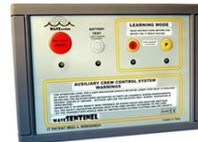
Sistema ausiliario di controllo MOB che avvisa acusticamente nel caso di caduta a mare di un membro dell'equipaggio ed in modo utile ed originale spegne il motore in caso di caduta a mare del comandante.
