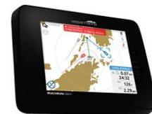
Il Vesper **WatchMate Vision2** è un AIS transponder (ricetrasmittitore) classe "B" dedicato, vincitore dell'Award NMMA per l'innovazione. Si distingue per un display touchscreen e per la facilità con cui può fornire le informazioni AIS ad altri dispositivi di bordo.
