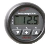
Il **VAH65** è un indicatore dei dati relativi alla batteria di bordo con la possibilità di monitorare la tensione di 3 gruppi di batterie. Lo strumento visualizza tensione batteria e corrente di carica e scarica. Applicando l'equazione di Peukert riesce a calcolare l'energia che è stata consumata e quella rimanente. E' possibile settare allarmi di alta e bassa tensione ed Ampere orarie rimanenti. Quando viene attivato l'allarme lo strumento emetterà un suono a 85 dB ed il display lampeggerà.
