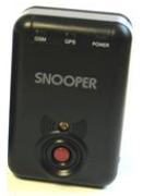
Invia su richiesta od automaticamente la posizione via GSM/GPRS per monitorare la posizione di un'imbarcazione o qualsiasi altro bene. La posizione può essere monitorata su mappa (satellitare, stradale od ibrida), direttamente sul telefonino o sul PC.
