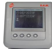
S.A.M. è un dispositivo elettronico integrato per imbarcazioni da diporto che segnala l'insorgere di condizioni di potenziale rischio per l'imbarcazione, sia ancorata in acque non protette che all'ormeggio in porto.
