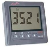
L'**RH110** è un **contagiri** nautico con la possibilità di visualizzare le ore moto ed il tempo trascorso. Può lavorare con ogni tipo di motore e può essere pilotato con varie frequenze ed ampiezze di segnale. Permette di impostare un allarme di fuori giri ed un allarme per la manutenzione (ad esempio per ricordare quando va effettuato il cambio olio). Quando uno degli allarmi viene attivato lo strumento emette un suono a 85 dB e mentre il display lampeggia.
