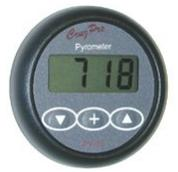
Pirometro PY60 misura la temperatura dei gas di scarico. Completo di sensore da 1100°C tipo K a termocoppia. Possibilità di impostare un allarme per temperatura alta/bassa e memorizzazione della temperatura massima. Provvisto di uscita **NMEA 0183**, utilizzabile anche come uscita per allarme esterno. Alimentazione 12/24 Vcc.
