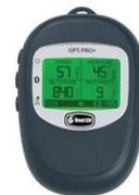
Sulla scia del successo del [GPS Pro](#), [Bad Elf](#) progetta il nuovo [GPS Pro+](#) aggiungendo alle funzionalità un sensore barometrico, il ricevitore della costellazione dei satelliti GLONASS e l'accesso all'hard disk interno tramite [USB](#).
