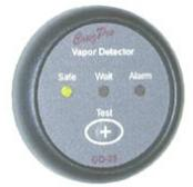
**CruzPro GD55 Gas detector** economico completo di sensore remoto. Lo strumento è in grado di rilevare i vapori del carburante (sia benzina che gasolio), manda un allarme quando i vapori superano il 25% della concentrazione necessaria per un'esplosione. L'allarme continuerà a suonare fino a che il livello di concentrazione sarà pericoloso.
