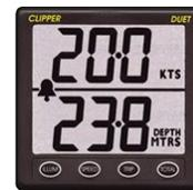
Tutta la gamma di strumenti elettronici Clipper dispone di un display di 110 millimetri, che permette una facile e chiara lettura dei dati, anche grazie ai vari livelli di retroilluminazione.
