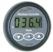
A differenza del CH55, il CruzPro CH30 è un vero computer a disposizione del verricello. Visualizza i metri di catena mollata e la tensione della batteria al verricello. Può essere programmato per rallentare automaticamente la salita dell'ancora quando rimane solo 1,5 Mt di catena, permettendo così di evitare bruschi colpi alla delfineria.
