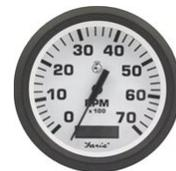
Faria Euro White contaore e contagiri 0-7000 rpm modello 32940, per motori fuori bordo con alternatore a 4, 6, 8, 10, 12 o 20 poli, selezionabili dietro il contagiri. Necessita di un foro per l'incasso di 85 mm. Dotato di retroilluminazione con alimentazione a 12 Vcc.
