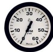
Faria 32904, serie Euro White, Contagiri analogico 0-6000 rpm per imbarcazioni con motori a benzina entro bordo ed entrofuoribordo a 4, 6, od 8 Cilindri. Necessita di un foro per l'incasso di 85 mm. Dotato di retroilluminazione con alimentazione a 12 Vcc.
