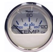
**Faria** 13828 serie Chesapeake Stainless Steel (SS) White indicatore temperatura acqua con lettura analogica 40-120°C. Opera attraverso il sensore temperatura art. [90412](#), da alloggiare sul motore attraverso gli adattatori art. [90604](#), [90605](#) o [90606](#). Necessita di un foro per l'incasso di 53 mm. Dotato di retroilluminazione con alimentazione a 12 **Vcc**.
