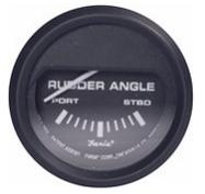
**Faria** 12833, indicatore angolo di barra con lettura analogica serie Euro. Opera attraverso il sensore di posizione art. [90530](#) da installare sulla timoneria. Necessita di un foro per l'incasso di 53 mm. Dotato di retroilluminazione con alimentazione a 12 **Vcc**.
