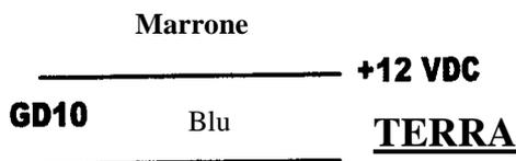
Applicare il 12VDC per accendere il GD10. Il LED verde lampeggerà per circa 2 minuti mentre il sensore del gas si scalderà. Quando il LED verde che indica “salvo” è acceso, l’unità è pronta a testare i vapori. Se vengono individuati vapori sopra il 25% LEL (più basso limite esplosivo), il LED lampeggerà verde e rosso e l’allarme suonerà. Premendo l’interruttore si disabiliterà l’allarme per alcuni minuti. Se il gas dovesse essere ancora presente, l’allarme del GD10 suonerà di nuovo.
