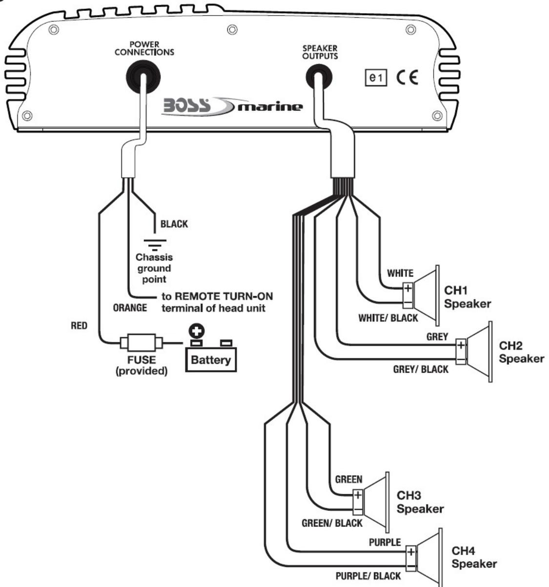
Schema connessioni per alimentazione e altoparlanti MR1200PA, modalità Ponte
