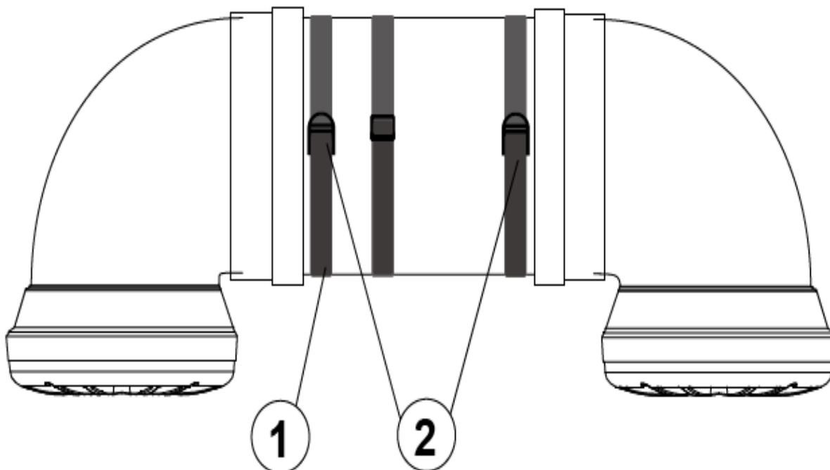
1. Avvolgere le 2 di cinghie di montaggio più grandi attorno ad un elemento ben fisso appartenente al telaio del vostro veicolo.
