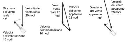
Imbarcazione in movimento sottovento La velocità del vento apparente è inferiore alla velocità del vento reale e la direzione del vento apparente è più prossima ad avanti diritto rispetto alla direzione del vento reale
