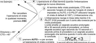
un'operazione di virata a sinistra 3 secondi all'inizio dell'operazione di virata ATTENZIONE: Nel modo Bussola virata automatica, la rotta da seguire varia secondo l'angolo di virata. Il G-PILOT non utilizza i dati provenienti da alcuna strumentazione per il rilevamento del vento. Esiste la possibilità che l'imbarcazione effettui una strambata o finisca in panne.
