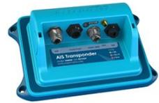
Il Vesper Marine WatchMate **XB-8000** è un transponder AIS classe "B" con GPS integrato che è anche in grado di convogliare tutte le informazioni già presenti sulla barca in NMEA 2000 e 0183, e trasmetterle via WiFi su tutta l'imbarcazione. Così potremo avere su smartphone e tablet tutte le informazioni di tutti gli strumenti di navigazione presenti in barca.
