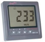
Il **VAF110** è un analizzatore di **corrente alternata** per le letture dei dati relativi alla tensione e corrente di banchina o del generatore, quali i Volt (da 90 a 300 VRMS), gli Ampere (0-150 A), la frequenza (30-110 Hz) ed i kW (0-45 kW). E' possibile selezionare un allarme sia per alta e bassa tensione che per alta e bassa frequenza. Quando l'allarme viene attivato lo strumento emetterà un allarme a 85 dB e il display lampeggerà.
