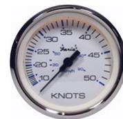
**Faria** 33822 serie Chesapeake Stainless Steel (SS) White **contamiglia** a pressione con lettura analogica e scala fino a 50 Nodi. Rileva la velocità tramite la **pipetta** opzionale art. **91109** o **91106** da installare a poppa. Necessita di un foro per l'incasso di 85 mm. Dotato di retroilluminazione con alimentazione a 12 **Vdc**.
