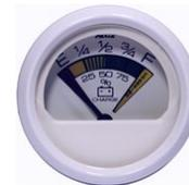
**Faria** Dress White Indicatore Livello Batteria analogico, modello 13125. Utile strumento per monitorare lo stato di carica delle batterie, con connessione diretta alla tensione in linea. Oltre a mostrare livello, indica anche quando la batteria è esaurita oppure è in fase di carica. Necessita di un foro per l'incasso di 53 mm. Dotato di retroilluminazione con alimentazione a 12 **Vcc**.
