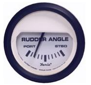
**Faria** 12931 Euro White indicatore dell'angolo del timone con lettura analogica. Opera attraverso il sensore di posizione art. [90530](#) da installare sulla timoneria della barca.
