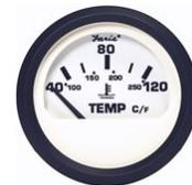
Serie Euro White **Faria** 12929, indicatore temperatura acqua con lettura analogica 40-120°C. Opera attraverso il sensore temperatura art. [90412](#), da alloggiare sul motore attraverso gli adattatori art. [90604](#), [90605](#) o [90606](#).
