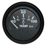
Serie Euro **Faria**, modello 12820. Indicatore temperatura con lettura analogica 20-100°C per motori fuoribordo. Fornito completo di sensore temperatura a contatto, da apporre sulla testata del cilindro. Necessita di un foro per l'incasso di 53 mm. Dotato di retroilluminazione con alimentazione a 12 **Vcc**.
