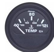
**Faria** serie Euro, modello 12814. Indicatore temperatura acqua motore con lettura analogica 40-120°C. Opera attraverso il sensore temperatura art. 90412, da alloggiare sul motore attraverso gli adattatori art. 90604, 90605 o 90606.
