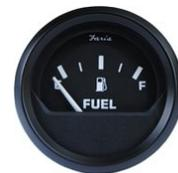
Serie Euro **Faria** 12802 indicatore livello carburante con lettura analogica. Opera Tramite i comuni Sensori di Livello di tipo Europeo con resistenza 10-180 Ohm come gli art. [91005](#) o [91007](#).
