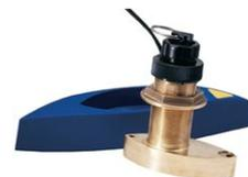
Tritrasduttore in Bronzo 500W (rileva profondità, velocità e temperatura) ad installazione passa scafo particolarmente indicata per chiglie in legno e metallo. Con entrambe le frequenze (50/200 kHz) fornisce informazioni ben dettagliate e ben definite sia nei bassi che negli alti fondali. Compatibile con black-box o plotter combinati [Nav-Station](#) e [Seiwa](#).
