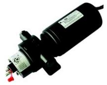
Pompa reversibile elettroidraulica da 0.2 a 2 Lt/Min con alimentazione a 12 Vcc. L'installazione avviene intercettando le linee di andata e ritorno dell'olio idraulico che muove il cilindro. Il movimento del cilindro nella funzione autopilota è trasferito attraverso la rotazione oraria e antioraria della pompa idraulica. Nella situazione stand-by non costituisce un impedimento al normale movimento del cilindro in quanto la pompa stessa è dotata di valvole di non ritorno.
