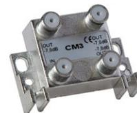
Il CM3 di **Scout** è uno splitter studiato per aggiungere ulteriori 2 uscite all'impianto di ricezione dei segnali TV. Il CM3 è realizzato in un contenitore pressofuso e consta di un ingresso e 3 uscite su connettori a vite di tipo F.
