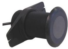
**ATU120AT CruzPro trasduttore** attivo in plastica con temperatura ad installazione passante, permette di visualizzare sullo strumento collegato il grafico del fondale con la relativa indicazione numerica della profondità e temperatura dell'acqua. Viene interfacciato tramite lo standard **NMEA 0183** al **plotter** dell'imbarcazione. Profondità massima rilevata 150 Mt. Cavo lungo 8 Mt, diametro Ø del foro per l'installazione 50 mm.
