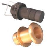
**Trasduttore** attivo in bronzo con temperatura **CruzPro ATB120AT** ad installazione passante. Il passa scafo è costruito in bronzo ed il **trasduttore** è estraibile per facilitarne la pulizia. Tramite la connessione **NMEA 0183** invia al **GPS** nautico i dati relativi alla profondità del fondale ed alla temperatura dell'acqua. Può rilevare la profondità fino a 150 Mt. Cavo lungo 8 Mt, Ø foro 50 mm.
