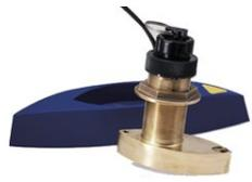
Tritrasduttore in bronzo ad installazione passante scafo, doppia frequenza (200kHz/50Khz - 14°/45°), con sensore temperatura e velocità. Lunghezza cavo 12 Mt, Ø foro 51 mm.
