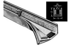
Guida singola rigida con lunghezza 2,44 mt, realizzata esclusivamente per uso marino, in acciaio inox AISI 316 amagnetico, con striscia in plastica sul fondo che facilita lo scorrimento del vetro e poggia a sua volta su un cuscinetto di feltro (vi si possono quindi affogare le viti). Setole laterali in materia sintetica non deteriorabile dagli agenti atmosferici, è inattaccabile da tarme, muffe e funghi.
